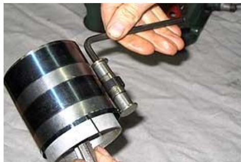
Figure 32 : compresseur de piston
