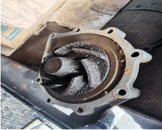
Figure 7 : pompe à eau grippé
