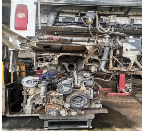
Figure 35 : élévation du moteur
