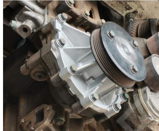
Figure 8 : pompe à eau changé
