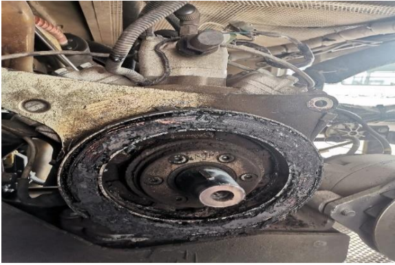
Figure 11: Bobine électro-aimant défectueuse
