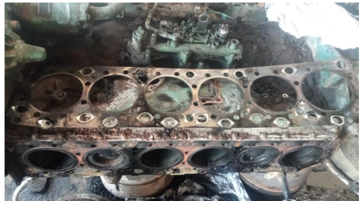
Figure II.6: Joint de culasse défectueux
