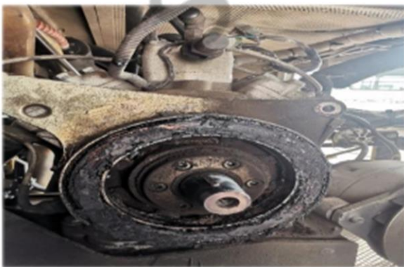
Figure II.11: Bobine électro défectueuse
