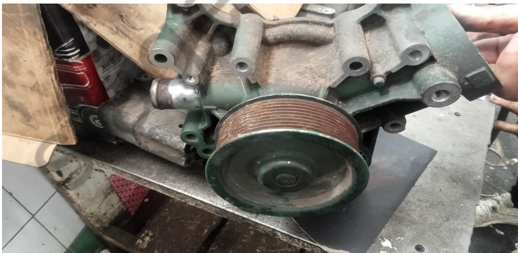
Figure II.7: Pompe à eau endommagé
