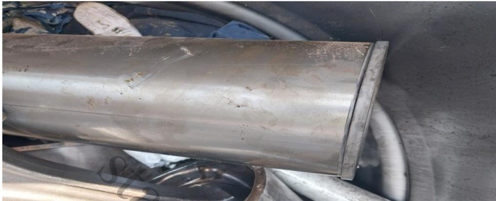
Figure 6: Chemise de cylindre
