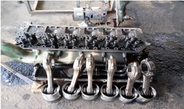
Figure 27 : piston démonté
