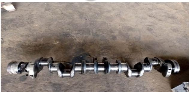
Avec la bielle il termine la transformation du mouvement rectiligne alternatif du piston en
