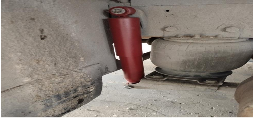
Figure 11: Changement d'un amortisseur arrière
