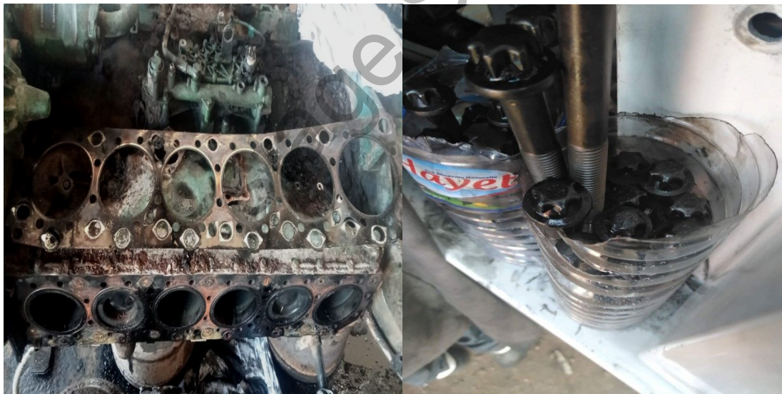
Figure 2. 1 : Moteur sans culasse + les 16 vis de la culasse
