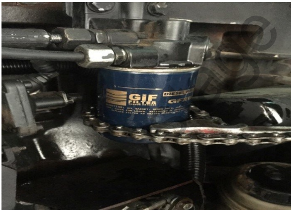
Figure 2.5 : Serrage d'un filtre à gasoil
