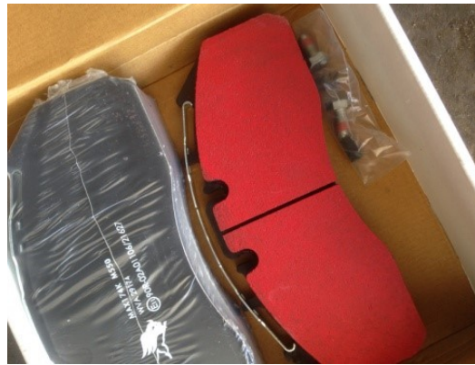
Figure 2.4 : plaquettes du frein
