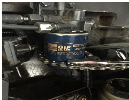
Figure 2. 7 : Serrage d'un filtre à gasoil
