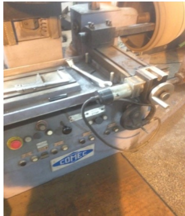
Figure 2. 10 : rectification d'un tambour
