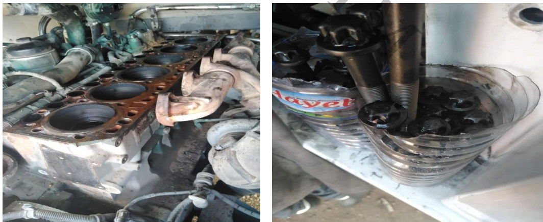
Figure 2. 1 : Moteur sans culasse + les 16 vis de la culasse
