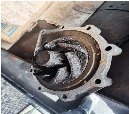
Figure 2. 3: pompe à eau grippé
